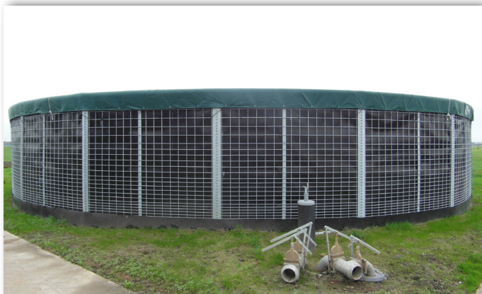
Silo en treillis
